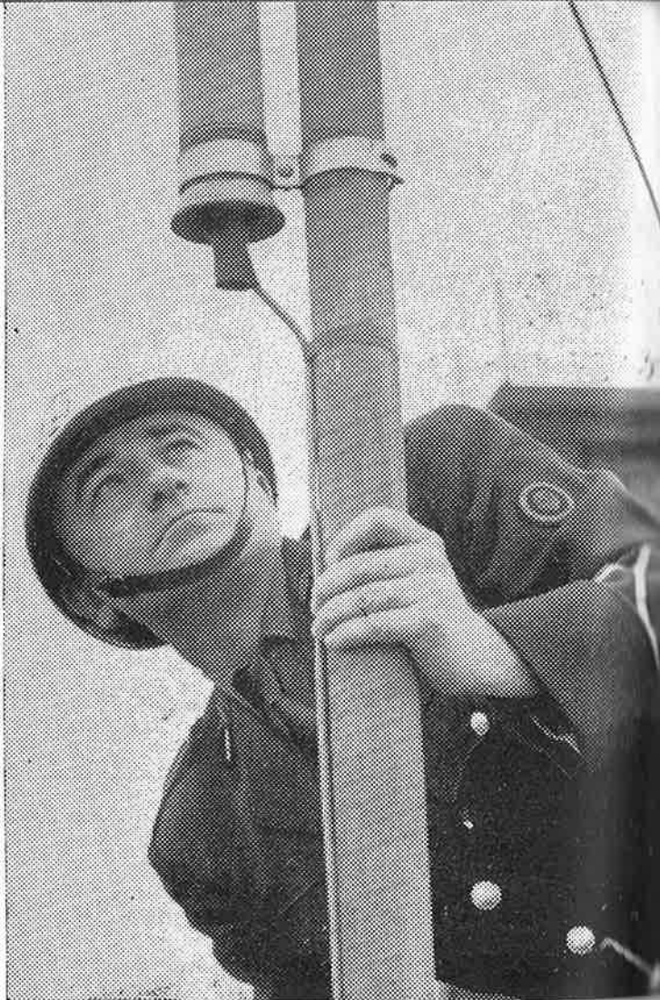
Un suboficial observa la cabeza superior del dispositivo de alarma radioactiva instalado en el Cuartel de Toulouse.
